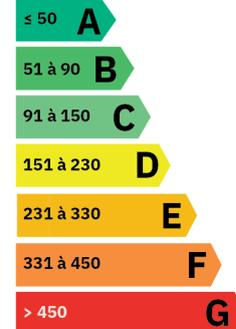
Emission de gaz à effet de serre en kgeq CO<sub>2</sub>/m<sup>2</sup>.an
